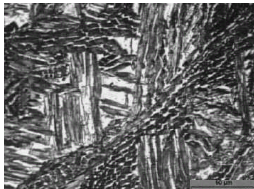
Figure II.1: Microstructure de la zone fondue d'un acier duplex soudé UNS S 31803 [26].
