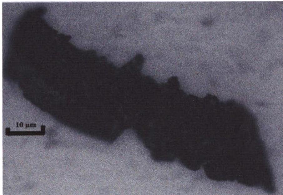
**Figure 2.** Photomicrographie optique montrant la forme initiale du copeau [9].
