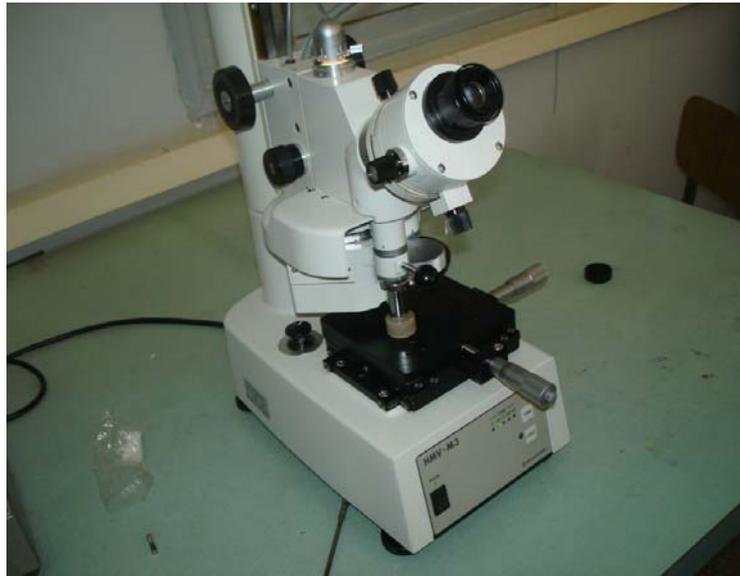
**Fig.13** : Micro-duromètre SHIMATZU HMV-M3
