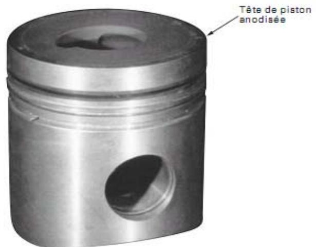
**Fig.6** : Tête de piston traité par anodisation dure [1]
