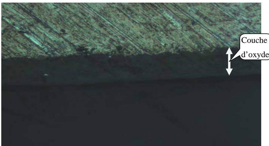
**Fig.2.2:** Couche obtenue en bain d'acide sulfurique à 15% (GX500)
