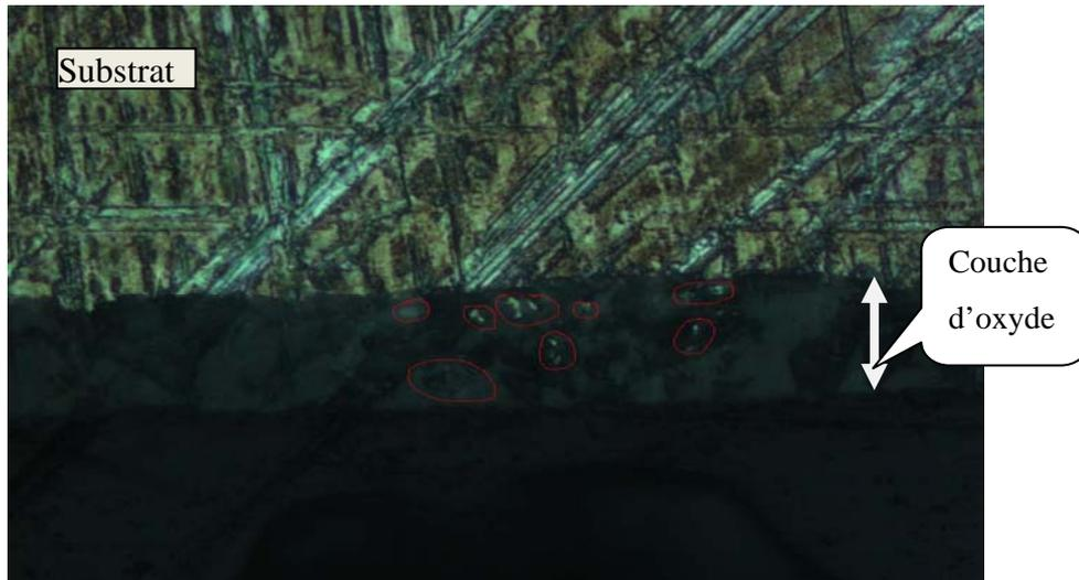
**Fig.1.4:** Couche obtenue en bain d'acide sulfurique à 25% (GX500)
