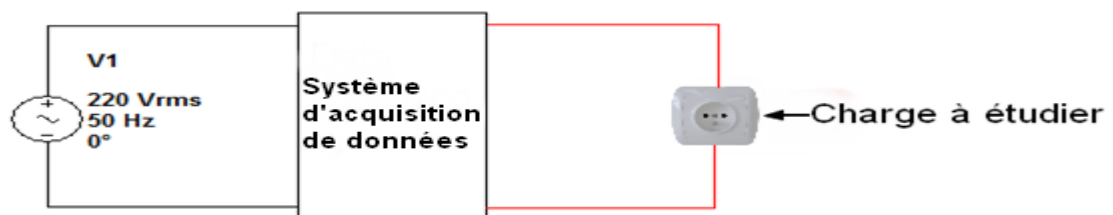
Figure III.1.1 Schéma du montage expérimental pour une charge isolée.
