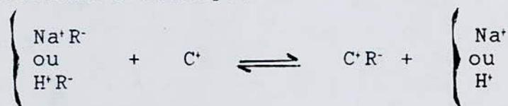
Régénération : dans la cas de l'échangeur cationique la régénération se fait par le passage soit d'une solution de NaCl, soit d'une solution de HCl ou encore de H<sub>2</sub>SO<sub>4</sub>. [20]
