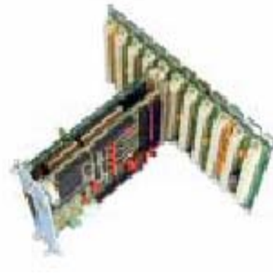
Figure III.1.b : Configuration de la carte en format 3U Sur un UBUS
