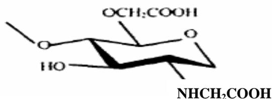
**Fig. 9 :** Structure chimique du N, O-carboxyméthylchitosane.
