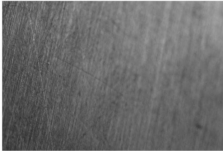
Figure (III.14) : l'acier poli avant essais électrochimiques non attaqué.
