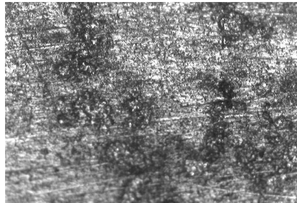
Figure (C.1.7) Boumerdès non stérile à 25°C piqûres de corrosion.
