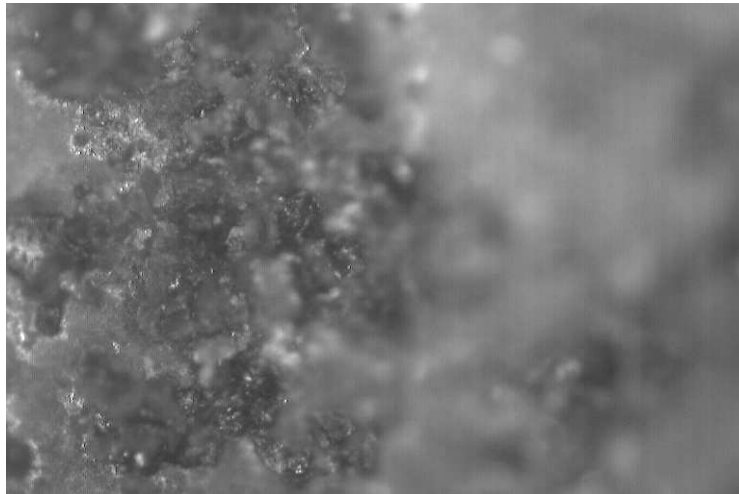
Figure (C.1.13) : Bejaia Ouest non stérile à 37°C, couche d'oxyde.
