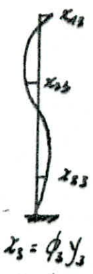
Représentation d'une déformée par une somme de composantes modales
