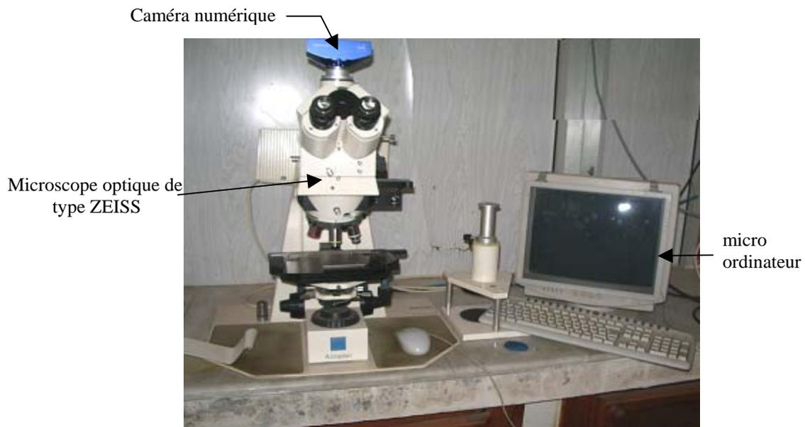
**Figure I.1.** Image du microscope optique utilisé pour la micrographie
