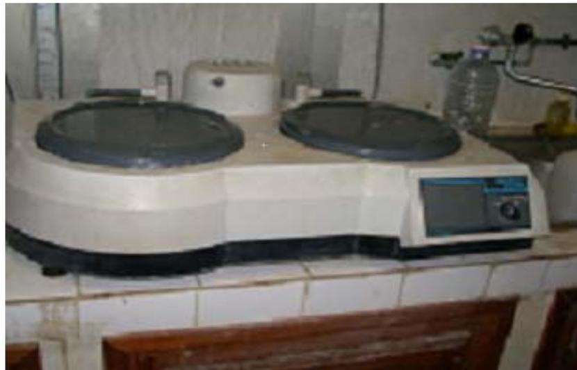
**Figure I.9.** Image d'une polisseuse
