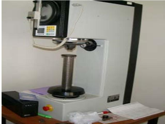
**Figure I.2.** Image d'un duromètre
