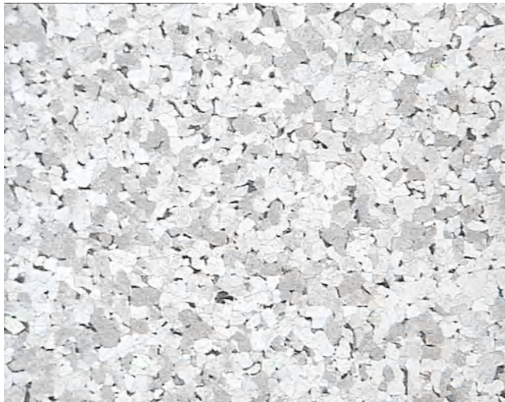
Figure 16. Microstructure de l'échantillon E1, après l'attaque chimique. Laminé par le quarto réversible. G100.
