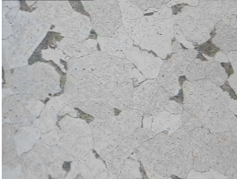
Figure 17. Microstructure de l'échantillon E1, après l'attaque chimique au nital. Laminé par le quarto réversible. G500.
