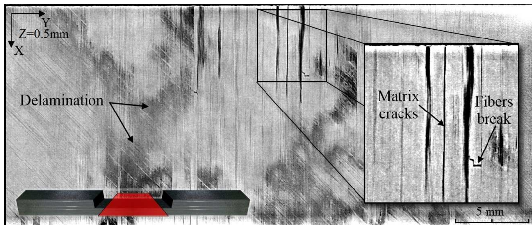
Fig. 4.19. Vue en coupe selon le plan (XY) de l'éprouvette qui a subi quatre paliers de chargement à 35%, 45%, 55% et 65% \delta f .
