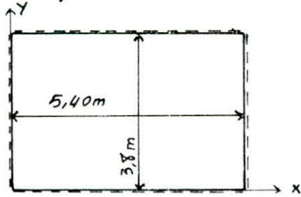
. charge triangulaire (à l'aide des tables de Barès on détermine  $M_{x\max}$ ,  $M_{y\max}$ )
