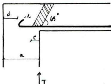
contrainte de compression simple dans la bielle de béton.
