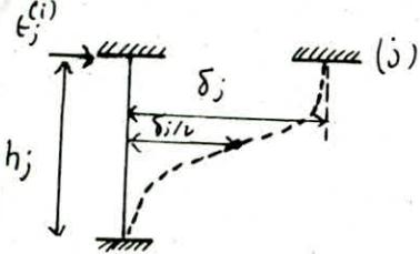
soit  $\Gamma_j^{(i)}$  la rigidité d'un poteau (*i*) du niveau (*j*) supposé encastré à ses extrémités (avec poutres infiniment rigides)
