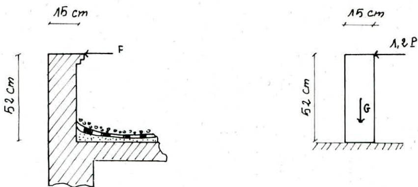
L'acrotere est assimilé à une console encastrée dans le plancher-terrasse, le calcul se fera par bande de 1m de largeur  $h = 52 \text{ cm}$ ; largeur  $b = 100 \text{ cm}$ ;  $e = 15 \text{ cm}$ . les efforts sollicitant l'acrotere sont :
