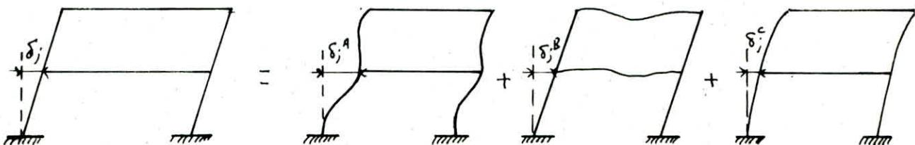
$\delta_j^A$  = déplacement de translation dû à la déformation de flexion des poteaux en supposant les poutres infiniment rigides.
