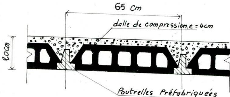
les planchers sont à corps creux ; ils sont constitués par des poutrelles préfabriquées associées aux corps creux (16 + 4) , ces poutrelles possèdent des armatures en attente permettant une bonne liaison avec le béton de la dalle de compression , ils seront disposés suivant le sens longitudinal du bâtiment , les poutrelles seront calculées sous la sollicitation du 1<sup>er</sup> genre G+1,8P le calcul se fait en 2 étapes .
