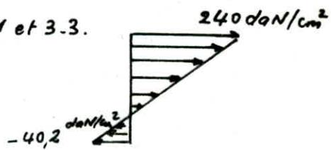
On constate que les contraintes de compression sont admissibles :  $\sigma' < \bar{\sigma}' = 0,60 \times 600 = 360 \text{ daN/cm}^2$
