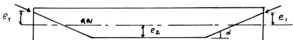
Les aciers utilisés pour la précontrainte sont des aciers à haute limite élastique (HLE) de diamètre  $\phi 8$ . Les aciers seront tirés avant le coulage du béton. On doit donc avoir une longueur des aciers correspondant à chaque élément.
