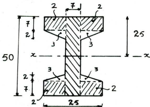
La section étant symétrique, l'axe neutre passe au milieu de celle-ci.
