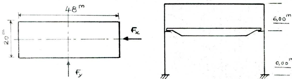
Les efforts sismiques  $F_x$  et  $F_y$  seront calculés respectivement aux niveaux : 6,00m et 9,12m (hauteur moyenne des portiques).
