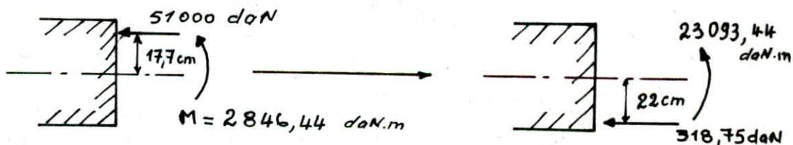
Si on place des armatures passives à 22 cm de l'axe neutre
