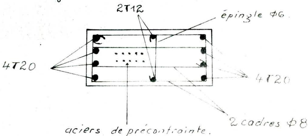
Remarque: Pour réduire la distance séparant les barres longitudinales, on ajoute des armatures de répartition : 2T12.
