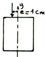
$$\tau_{bm} = \frac{k \cdot M_t}{b^2 \cdot h} \text{ avec } k \text{ une fonction de } b \text{ et } h \text{ donnée par des tableaux.}$$
