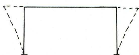
Diagramme qui pourrait être inversé pour une diminution de température .
