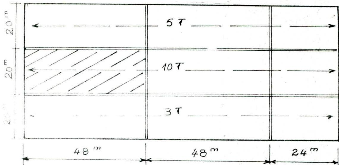
Puisque nous avons une structure à plusieurs blocs séparés par des joints de dilatation, nous ferons l'étude au séisme seulement pour une partie du bâtiment.
