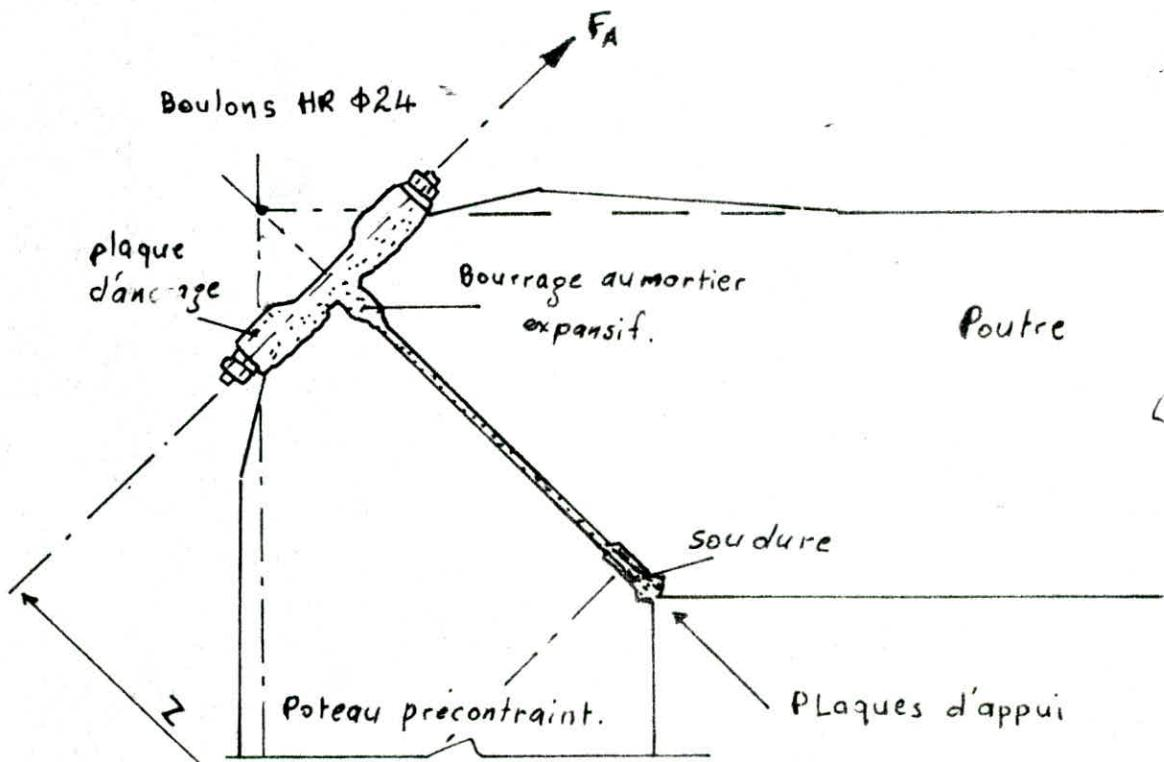
Le procédé présente l'intérêt de pouvoir appliquer un couple de serrage au niveau du noeud de fagon à diminuer le moment en travée de la poutre si celui-ci n'est pas admissible. Ce couple de serrage est égal à :  $C_1 + C$  où  $C_1$  est le couple nécessaire à visser sans serrer. On serre le strict minimum pour avoir un noeud hyperstatique.  $C_1$  est le moment additionnel que l'on doit appliquer en cas où le moment en travée n'est pas admissible afin justement de diminuer ce moment.
