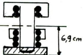
L'excentricité de l'acier équivalent au niveau de la section 1-1 (section rectangulaire) sera :
