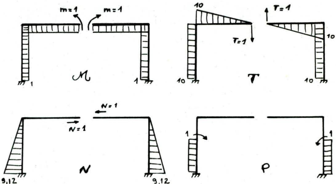
Les différents déplacements relatifs sont donnés dans les tableaux de MOHR sous forme de produits de diagrammes. Nous avons donc utilisé ces tableaux, ce qui donne :
