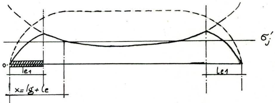
Dans ce schéma le cumul des contraintes dépasse la contrainte admissible entre l'about et le point A un gainage est nécessaire sur une longueur  $l_{g1}$  telle que:
