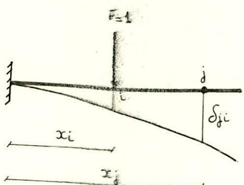
pour une structure d'inertie constante le déplacement  $\delta_{ij}$  de la section  $j$ , due à une force unitaire  $F=1$  appliquée en  $i$  est donné par la formule :
