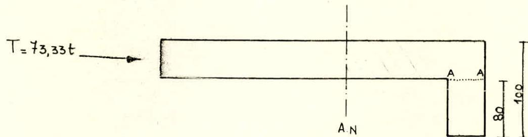
La section risque de se cisailler suivant les sections A-A
