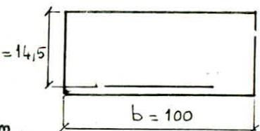
Soit alors  $5 \text{ T12} = 5,65 \text{ cm}^2/\text{ml}$  espacés de  $t = 20 \text{ cm}$ .
