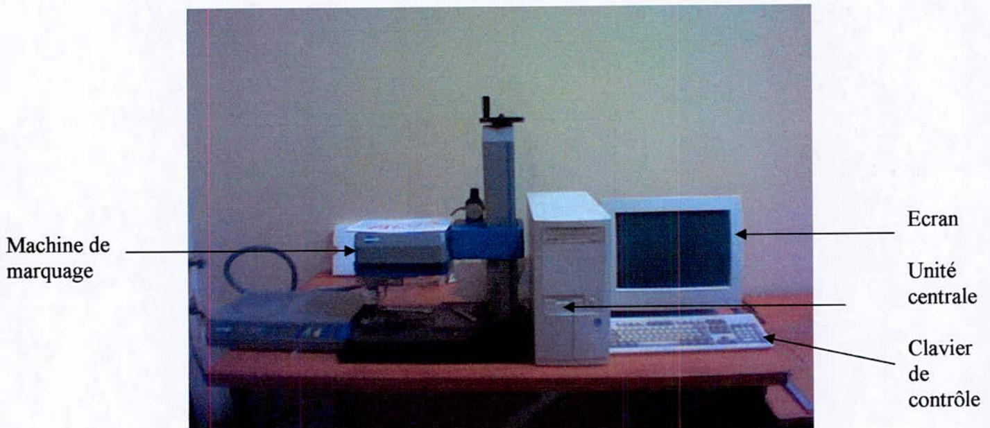
Figure II-7 : Montage de la machine d'impact par percussion.
