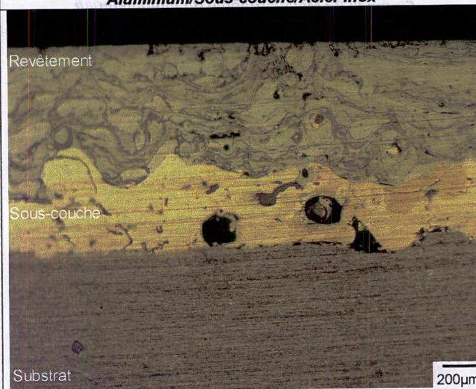
**Figure III-12 : Métallographie du multimatériau traité Aluminium/Sous-couche/Acier Inox**
