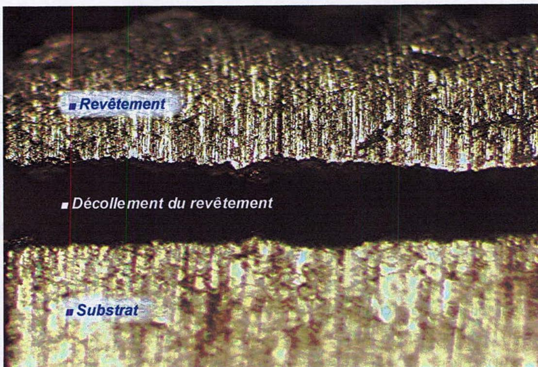
**Figure III-7 : Métallographie du bimatériau Acier XC18 / Acier Inox montrant le décollement du revêtement d'Acier Inox Grossissement X200.**
