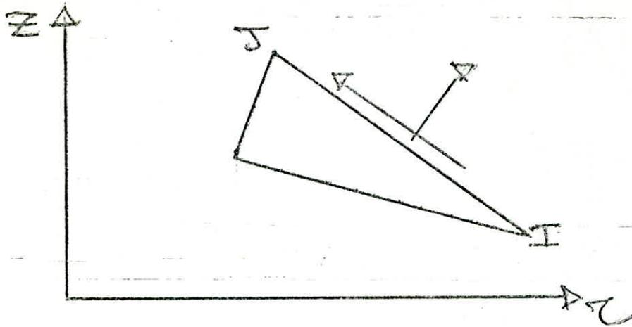
Pour le calcul des forces uniformément réparties, on doit transformer les forces sur chaque face en forces normales et tangentielles en chacun des 2 noeuds de la face considérée.
