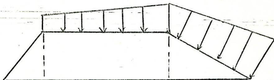
On peut décomposer la surface trapézoïdale en 1 surface rectangulaire et 2 surfaces triangulaires. Pour la surface rectangulaire, la distribution des forces se déduit simplement, mais pour les forces trapézoïdales sur les surfaces triangulaires, on peut les calculer à partir des intégrales.
