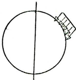
Pour les forces surfacique, dans les cas de déformation planes et contraintes planes, on a pu faire une approximation, en considérant que les forces revenant aux noeuds d'une face considérée, est représentées par les réactions d'appuis, car nous avons des forces trapézoïdales sur un élément plan.
