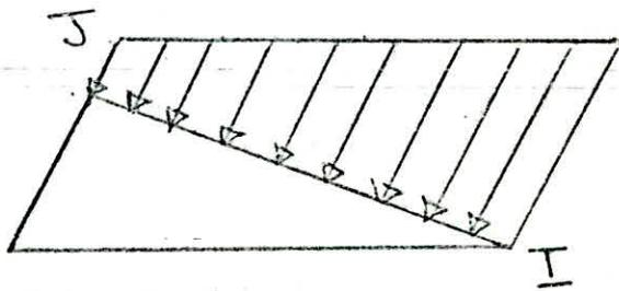
On décompose les forces aux noeuds  $I$  et  $J$  en forces normales et tangentielles. Les forces résultantes sont les réactions d'appuis.
