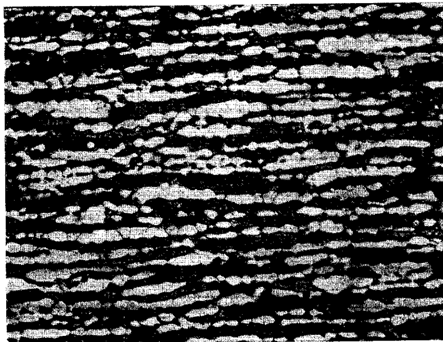
Fig.16 Observation au microscope optique de l'acier duplex 2205 traité à 1100°C.
