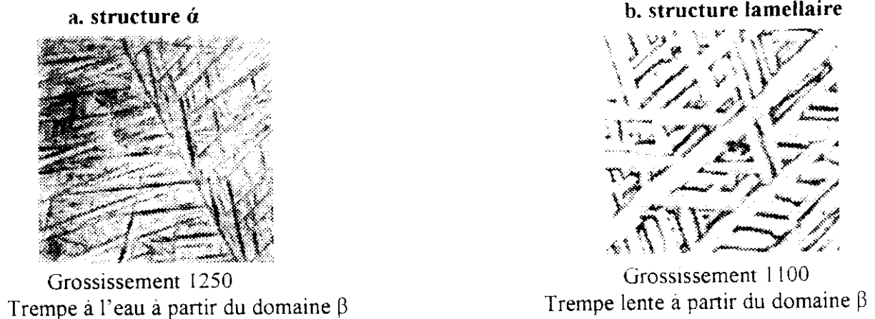
Figure II.4 : Exemples de morphologie que l'on peut obtenir à partir du domaine \beta [18].
