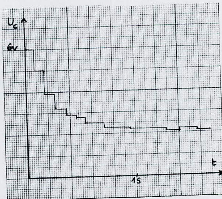
Fig. III.8 - REPONSE DE LA TENSION DE COMMANDE POUR UN ECHELON DE CONSIGNE .
