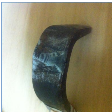
Figure21 : pliage endroit E=8mm sens transversal
