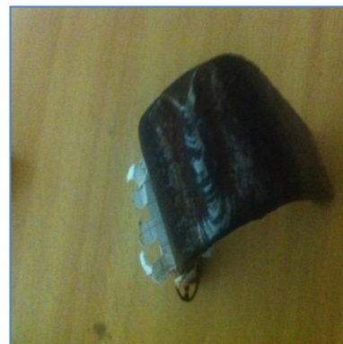
Figure22 : pliage endroit E=8mm sens longitudinal
