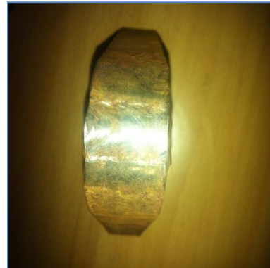
Figure26 : pliage endroit e=5mm sens longitudinal
