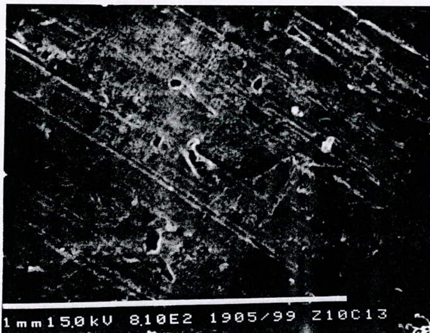
Photo n°4 : Observation au MEB. Structure du revêtement après une série de 15 chocs, à température de 500°C, temps de maintien 6min
