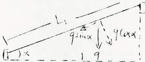
Le moment dans la paillasse inclinée est le même que celui de la poutre horizontale chargée de  $q/ml$  pour un mètre d'enmenchement
