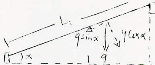
Le moment dans la paillasse inclinée est le même que celui de la poutre horizontale chargée de  $q/ml$  pour un mètre d'enmencement
