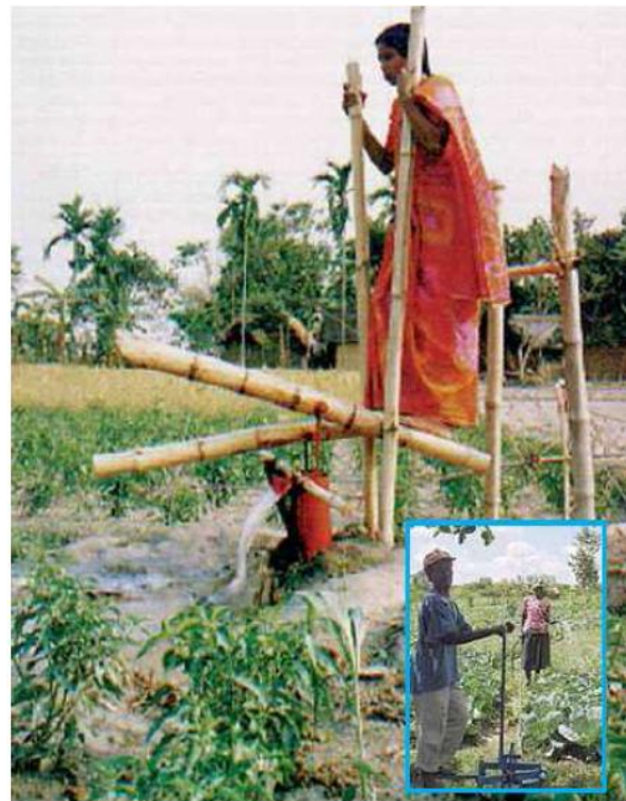
Fig. 2-4 : Une personne actionnant une pompe à pédales aspirantes [37].
