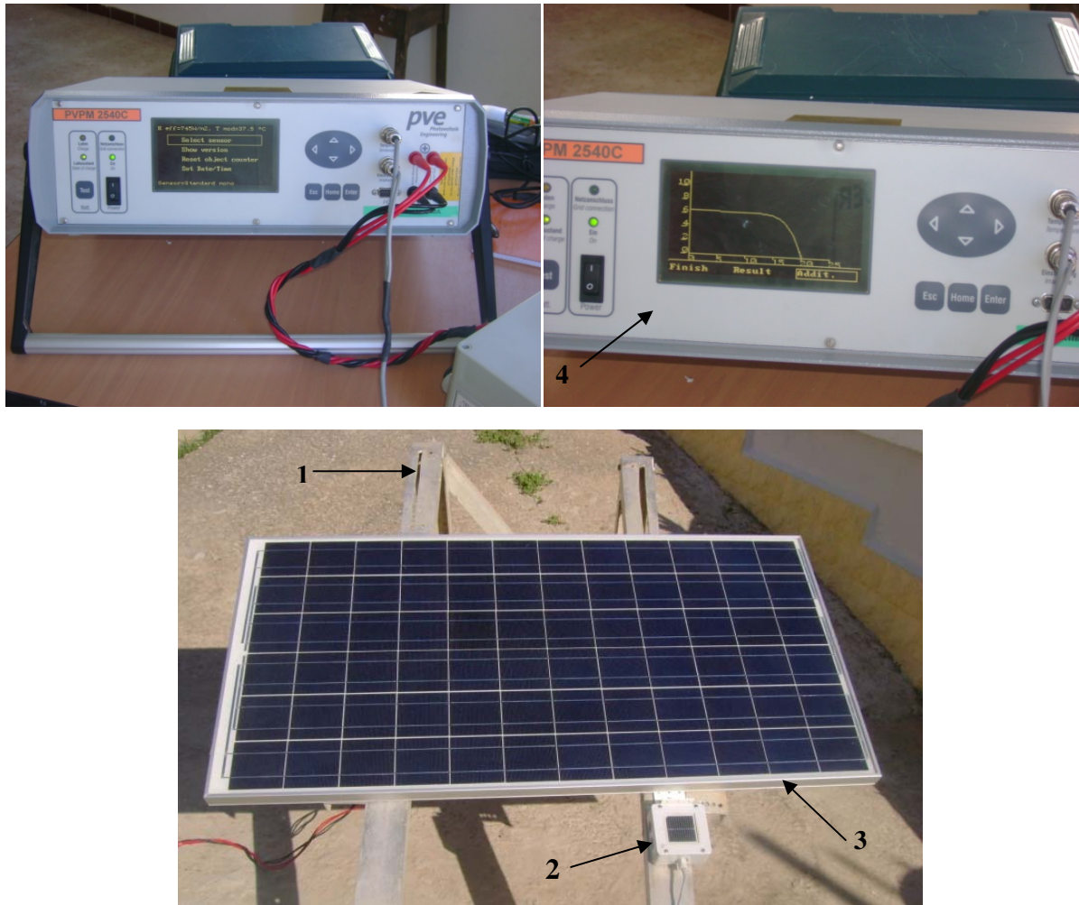
Fig. 4-3: Banc de mesure pour la caractérisation du module PV
