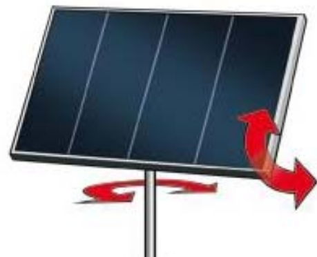
Fig. 2-13 : Générateur PV avec système de poursuite bi-axial
