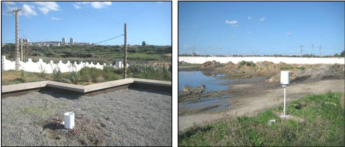
Photo IV.1: Installation des pluviomètres
