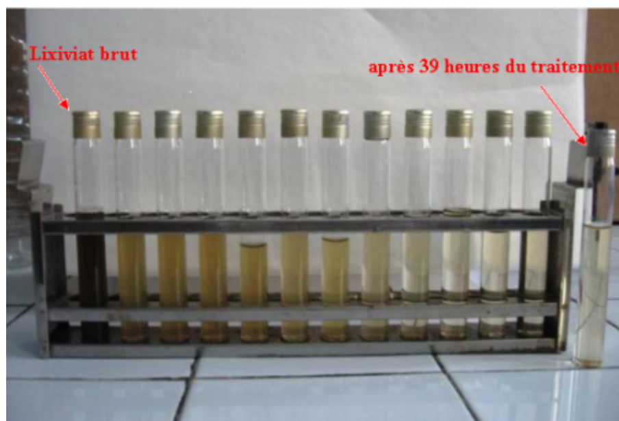
Photo des tubes, contenant du lixiviat brut et des lixiviats obtenus après traitement réalisé à pH maintenu à 5.
