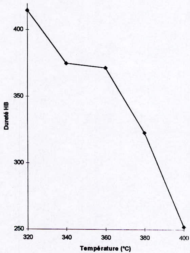
Fig 3.14 : Variation de la dureté HB en fonction de la température pendant un temps de maintien de 8H.
