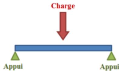
Figure IV. 1: Configuration de l'essai de flexion à trois points.
