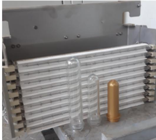
Figure 1-14: Exemple de préforme ISIS en PET (Usine de production de Henkel, Reghaia)
