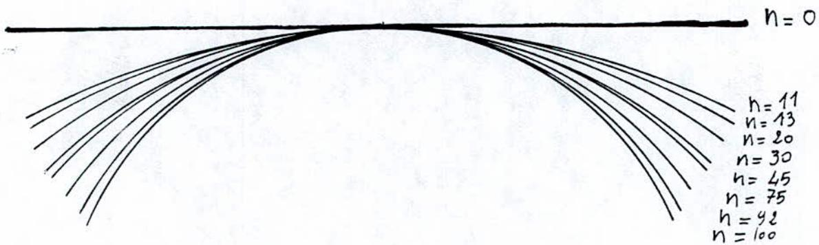
Figure 6: Evolution de l'emprunte de l'éprouvette durant le traitement d'éducation .
