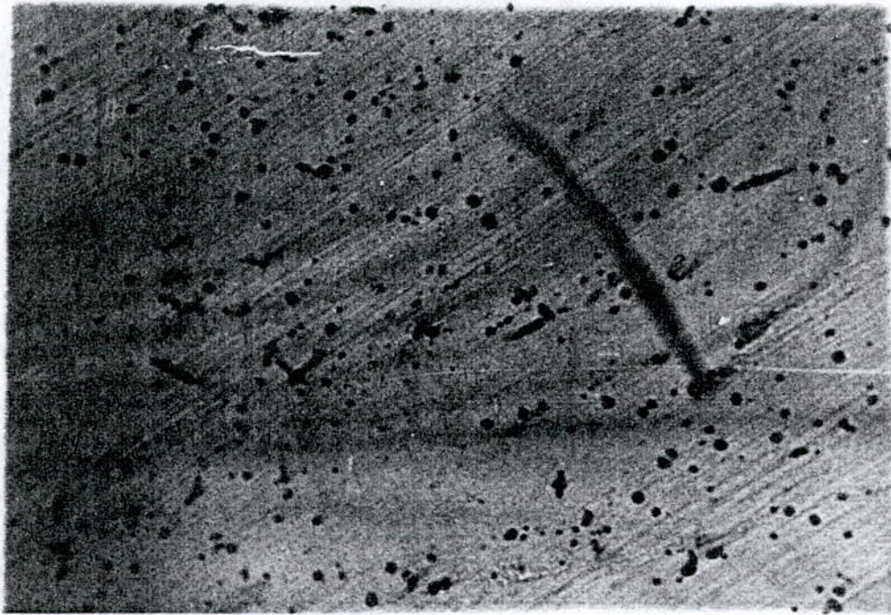
Figure 6.1. particules de seconde phase \beta dans un échantillon de référence pour l'alliage Ag - 10%Cu . L'échantillon est déformé par laminage ( \epsilon = 0,3 ) puis homogénéisé pendant 2 heures à 750 °C ( G = 500 ).
