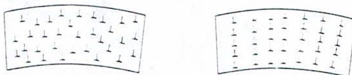
figure 2.5 (a) Excès de dislocations coins produits par pliage (b) L'alignement des dislocations après polygonisation
