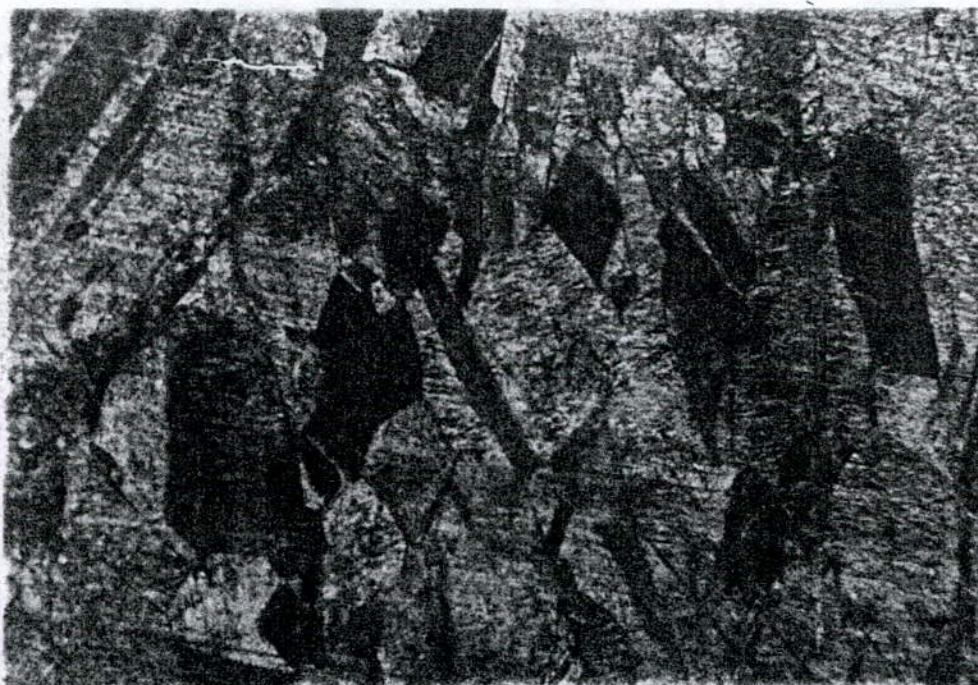
figure 6.5 structure d'un échantillon d'argent pur déformé par laminage à froid, \epsilon = 0,8 . ( G = 100 ).
