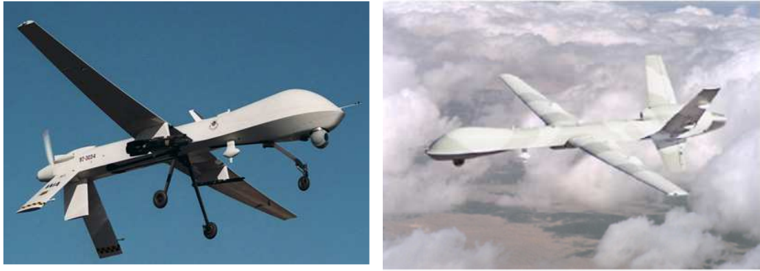
Figure 2. 3: Le Predator, drone MAE multi missions, utilisé par l'US Air Force depuis 1995.
