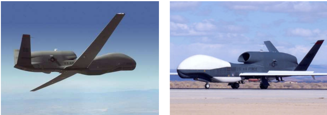
Figure 2. 1: Drone militaire de surveillance: Global Hawk (Northrop Grumman, 1000kg De charge utile).
