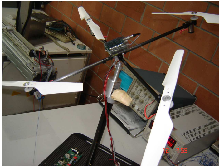
Figure 5. 11 : La centrale inertielle 3DM-GX1 montée sur le système du quadrotor.
