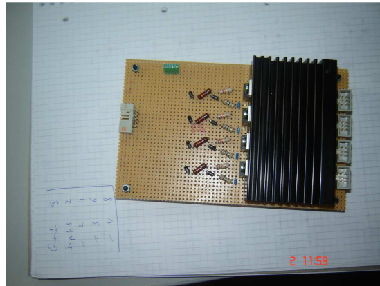
Figure 5. 16 : La carte de puissance réalisée à base des amplificateurs opérationnels de puissance OPA548
