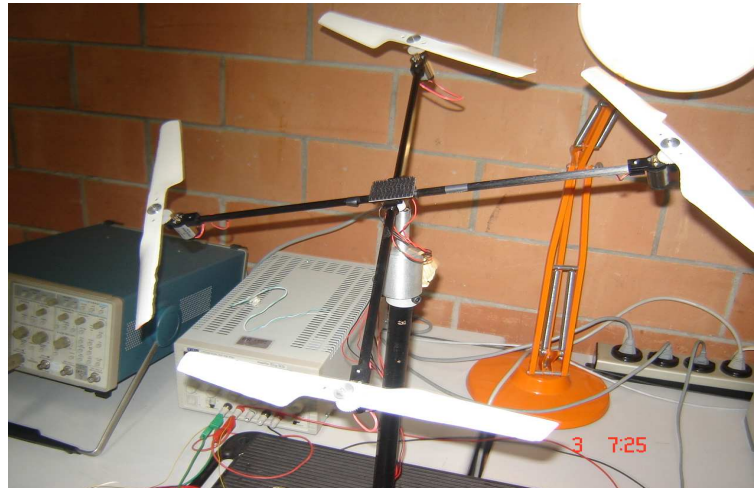
Figure 5. 7 : La maquette du quadrotor de l'EPFL(Test Bench)
