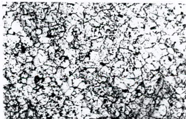
Fig (6.40) structure de l'acier A 34.2 recuit à 880°C et t=15mn (x200)
