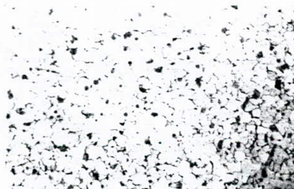
Fig (6.28) structure de l'acier A 37.2 recuit à 880°C et t= 15mn (x200)
