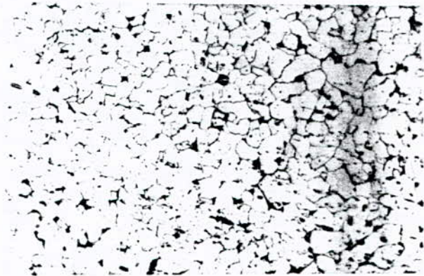
Fig (6.35) structure de l'acier A34.2 recuit à 860°C et t= 10mn (x200)
