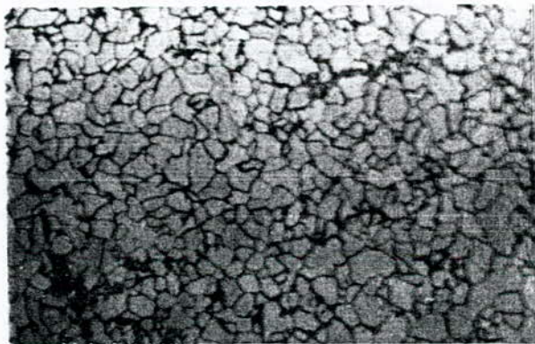
Fig (6.4) structure de tube recuit à 920°C pendant 6mn de l'acier A 37.2 (x200)
