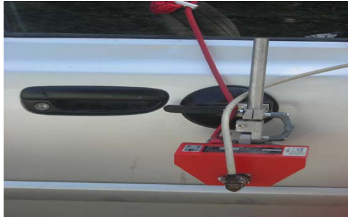
Figure 19 : Cinémomètre installé accroché à la portière d'une voiture.
