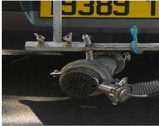
Figure 22 : embout formé de 112 tubes.
