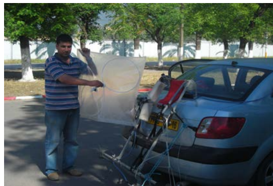
Figure 23: Sac TEDLAR et autres matériels embarqués à l'arrière d'un véhicule.
