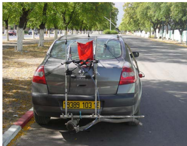
Figure 26 : Renault Mégane avec le système mini-CVS.
