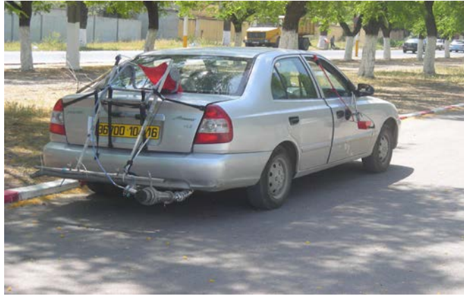
Figure 25 : Hyundai Accent équipé avec le système mini-CVS.
