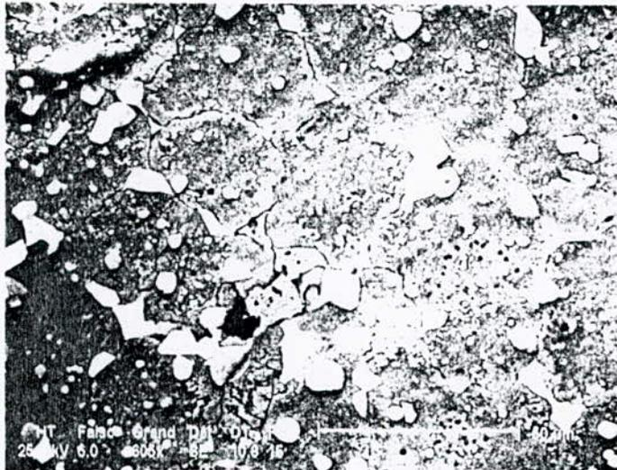
Fig. (VIII-6) : Echantillon d'acier T15 fritté pendant 1h $\frac{1}{2}$  à 1250°C.
