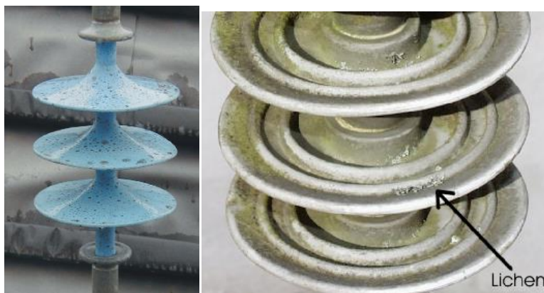
Figure 4: Isolateur attaqué par des champignons à gauche et le Lichen à droite [33].
