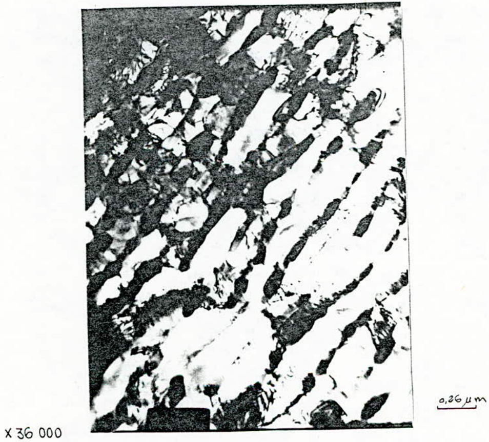
fig 3.10 cémentite partiellement sphéroïdisée
