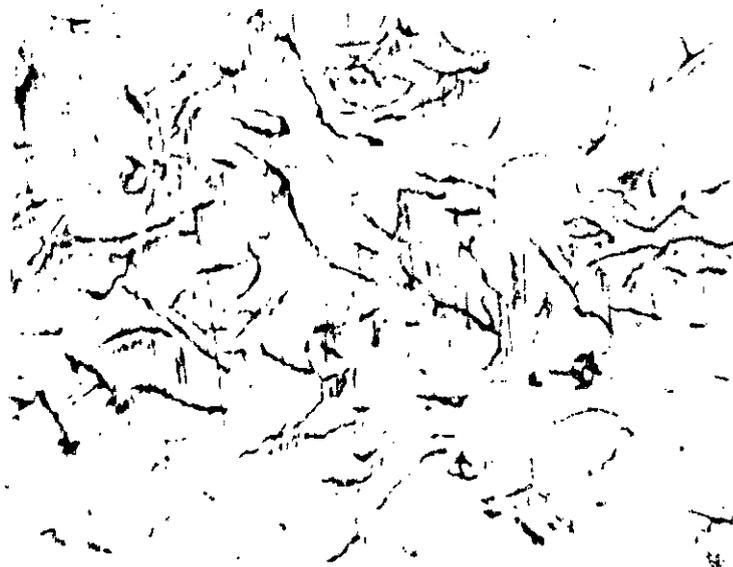
Selon I. Lakhtine [10], le graphite lamellaire a une influence importante sur les propriétés mécaniques de la fonte, qui sont même déterminées par leur composant graphitique. Le graphite joue le rôle d'entaille affaiblissant la matrice métallique, dans ce cas, les propriétés mécaniques dépendent de la quantité, des dimensions, et de la distribution des inclusions de graphite.
