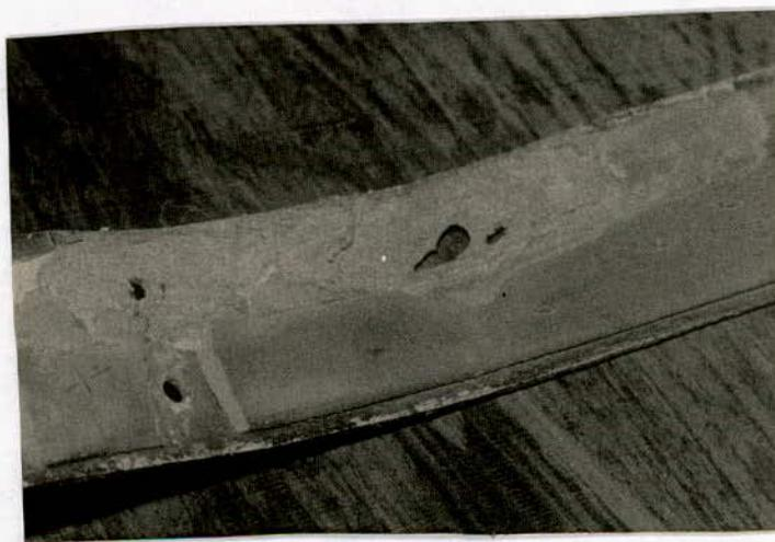
Photo II-1 Echantillon corrodé prélevé sur site
