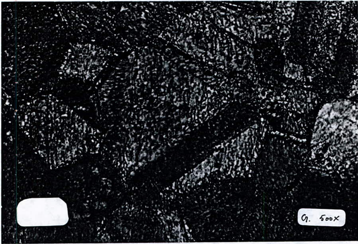
micrographie 1 : Cupro-nickel (structure métallographique)
