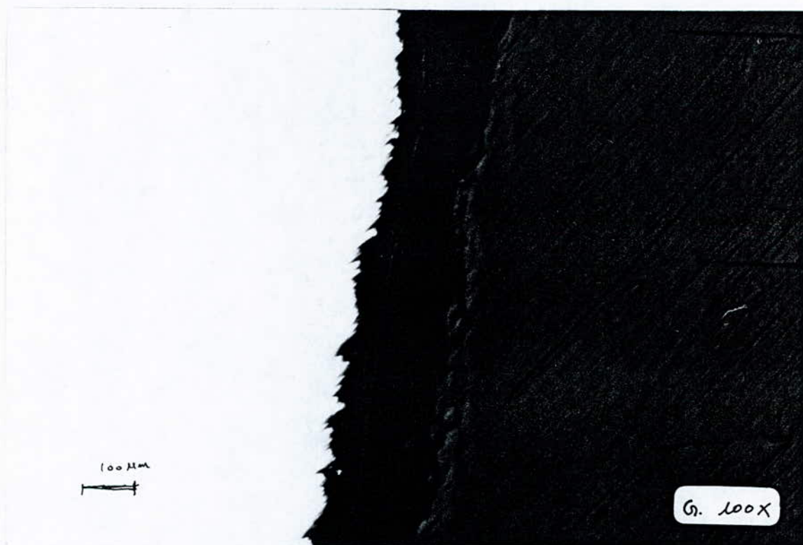
micrographie 15 : Nickel pur (-Cu) (Essai dans l'eau salée) "eau de mer")
