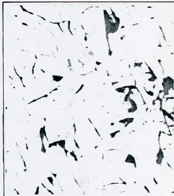
Fig - IV - 8 ep = 170 mm Graphite en Lamelles uniformément réparties + Graphite en Lamelles grossières . 100x (sans attaque)
