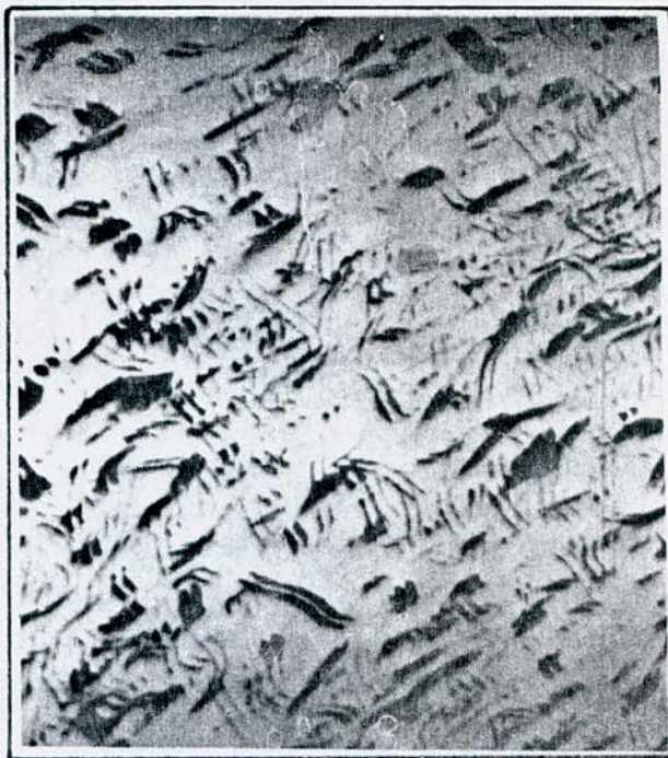
Fig - IV - 6 ep = 125 mm Graphite en Lamelles uniformément réparties x 100 (sans attaque)
