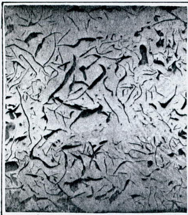
Fig - IV - 5 ep = 110 mm Graphite Lamellaire en rosettes + Graphite en Lamelles uniformément réparties x 100 (sans attaque)
