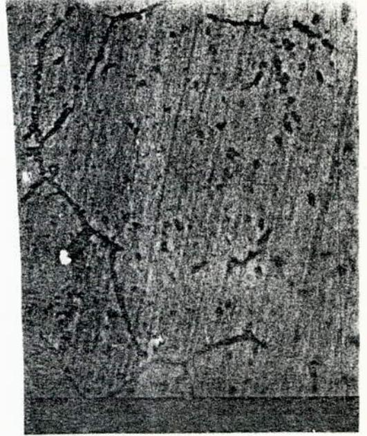
Fil d'aluminium recuit à 200° pendant 1h30m après une déformation de 3%
