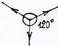
Fig. 5: Equilibre des tensions interfaciales de trois grains.
