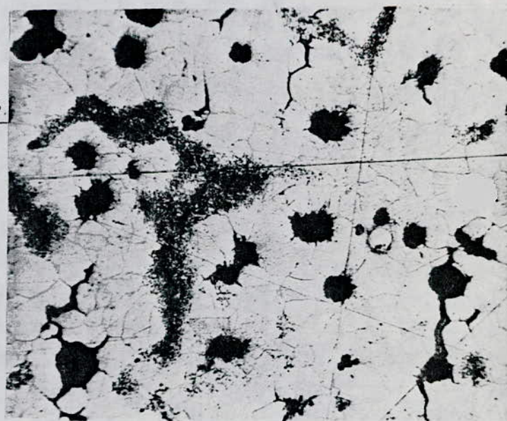
Fig 20 : Evolution Structurale lors des Chocs Thermiques de La Structure Ferritique de La Fonte G.S.
