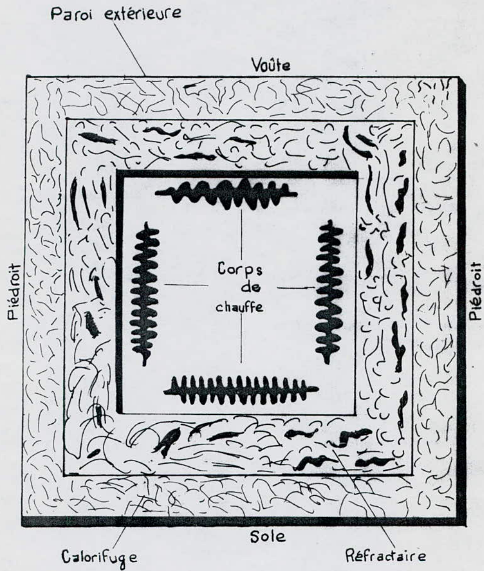
Fig 9. Représentation schématique d'un four à Résistances.
