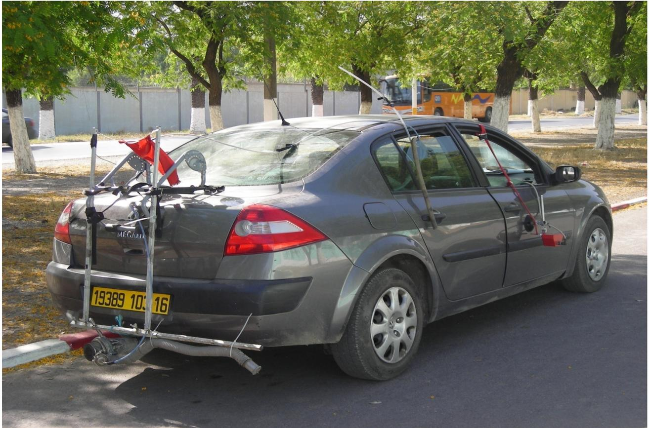
**Figure 20. Photo véhicule Mégane équipé du Mini CVS (arrière du véhicule) et du cinémomètre (porte avant droite)**
