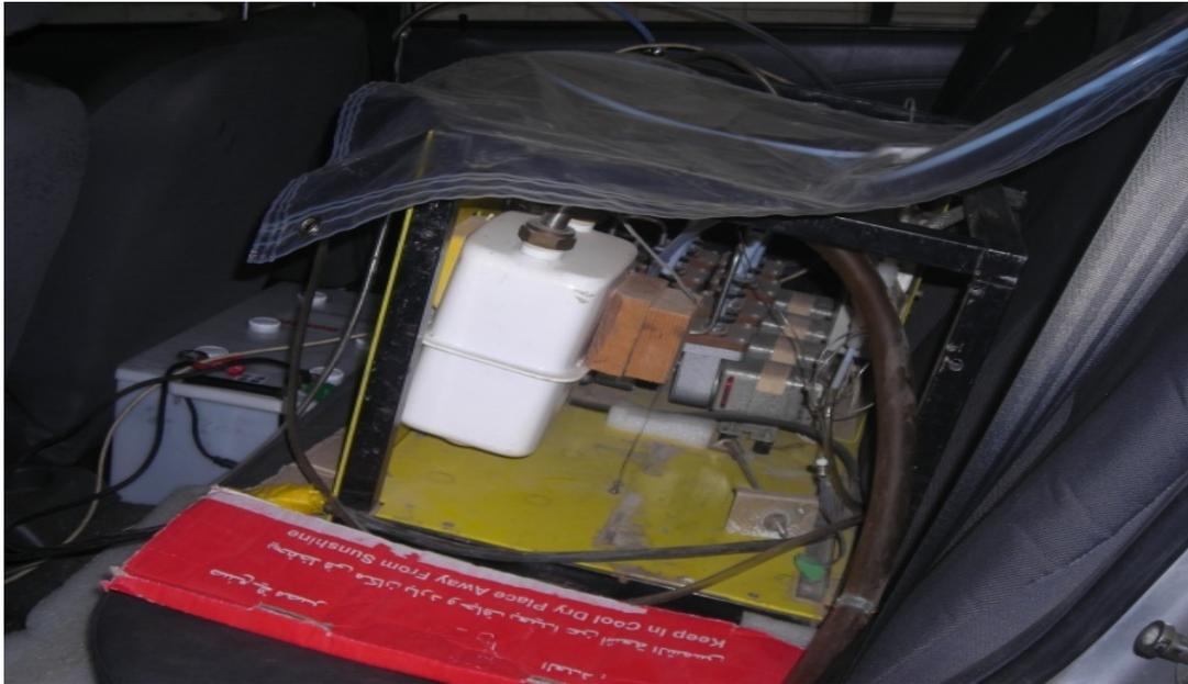
Figure 21. Système de pompage d'air sur banquette arrière du véhicule
