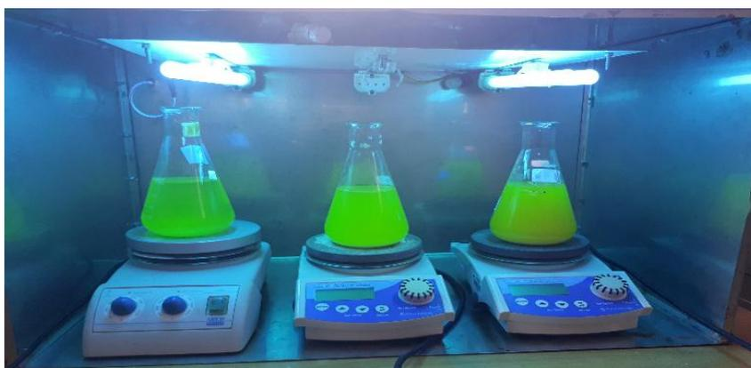
Figure 2. 1: Dispositif expérimental de photo-catalyse en mode batch.
