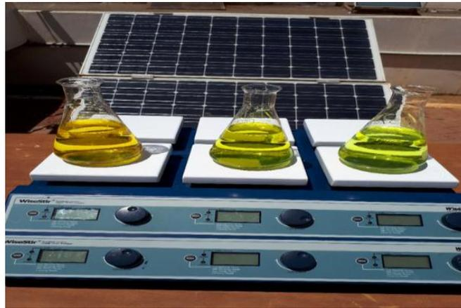
Figure 3. 1: Dispositif expérimental utilisé pour la dégradation photo-catalytique de la tartrazine sous rayonnement solaire.
