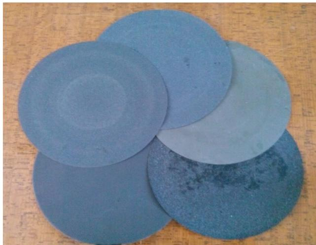
Figure 2.8 : Papiers abrasifs de pré-polissage.
