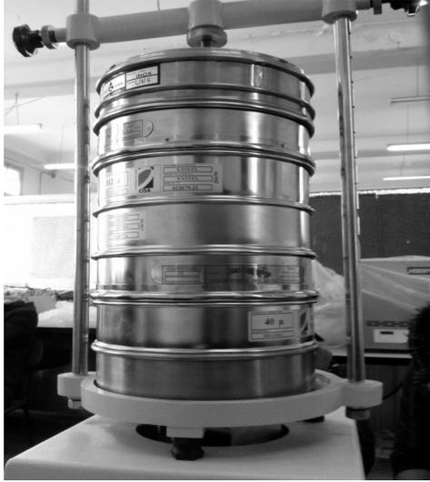
*Figure 2.1 : Tamiseuse utilisée pour la caractérisation.*
