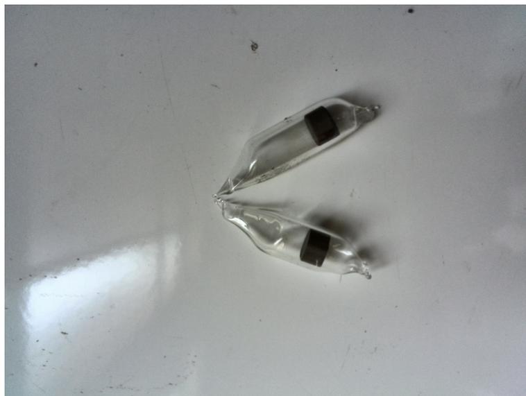
*Figure 2.5* : le comprimé de poudre encapsulé à l'intérieur d'un tube en verre .
