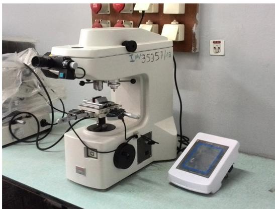
***Figure 2.12*** : Photo d'un microduromètre.
