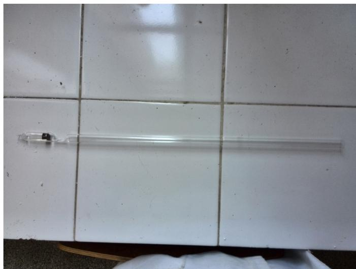
*Figure 2.3 : Capsule à une des extrémités d'un tube en verre.*
