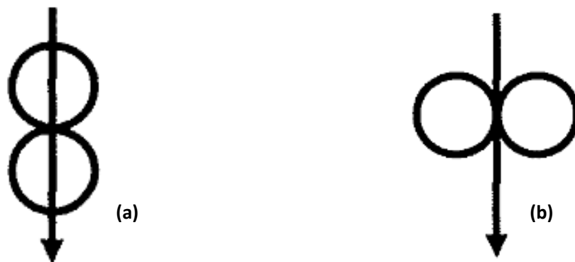
Figure III. 2: Orientation du bispot par rapport à l'axe de soudage.
